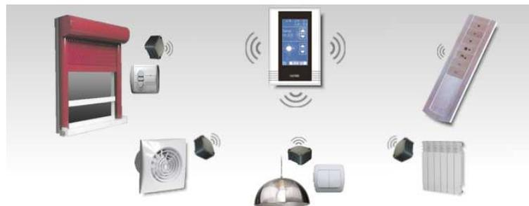
Задачей узлового устройства является выполнением заданий контроллера с внешними объектами таких как: лампы, жалюзи, обогреватели, кондиционеры, сигнализации и сбор информации о состоянии датчиков, таких как переключатели, датчики температуры, освещения или движения.
