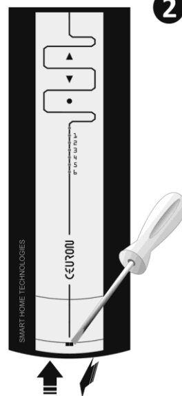
Rys. 3. Sposób wymiany baterii w urządzeniu.
